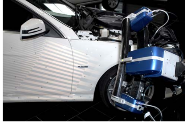
3D-Scannen einer bestehenden Karosserie für individuelles, präzises Fahrzeug-Tuning
