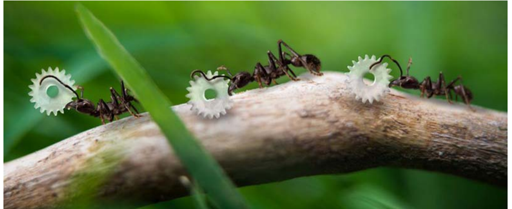
Durch selektives laserinduziertes Ätzen hergestellte Mikrozahnräder im Größenvergleich.
