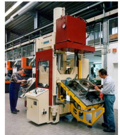
Die Tuschier- und Versuchsspritzpresse TUS80 von Reis kann je nach Kundenwünschen ausgebaut werden.
